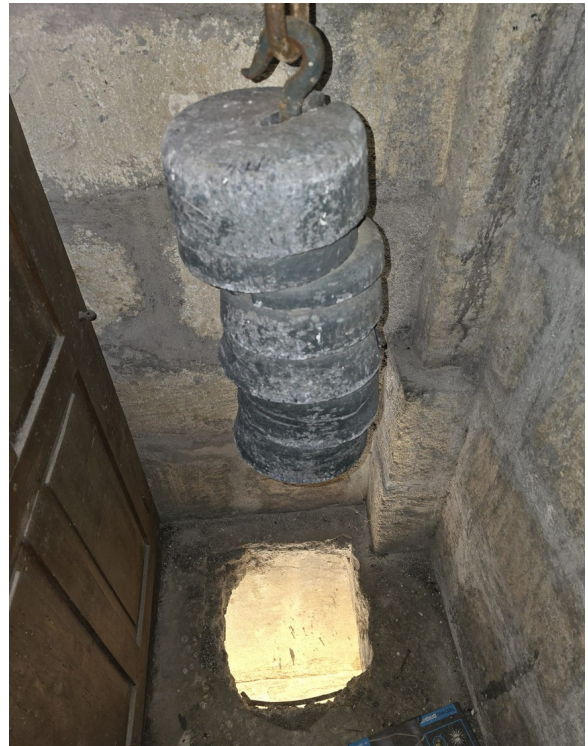
Mécanisme de l'horloge vu de côté Contrepoids et trou de passage
