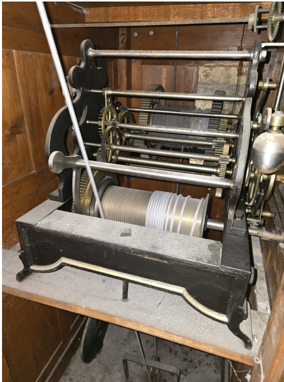
Mécanisme de l'horloge vu de côté Contrepoids et trou de passage
